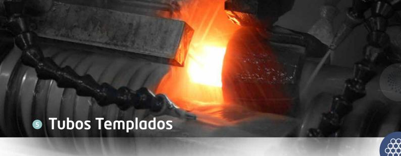
El temple por inducción se basa en el calentamiento del material a través de su paso por un campo magnético de alta densidad. La penetración del calentamiento es función directa de la frecuencia de trabajo. Un control preciso sobre esta permite asegurar una homogeneidad perfecta del temple
